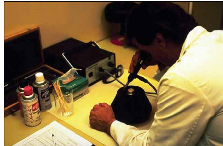
Obr 8: Prohlídka kavit rotoru boroskopem
