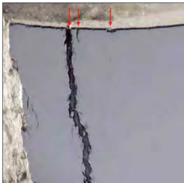
Obr 6: Řez hliníkovým rotorem s hloubkovou prasklinou
