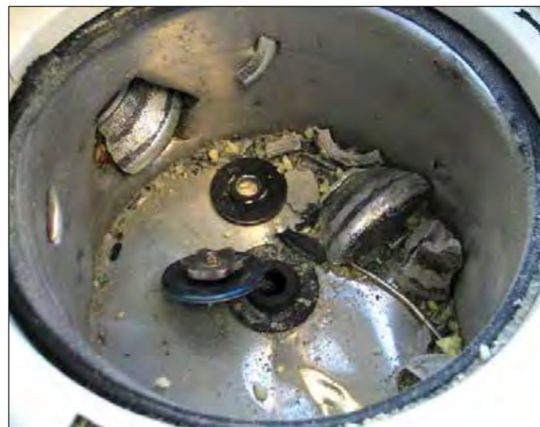
Obr 7: Rotorový prostor centrifugy po havárii rotoru
