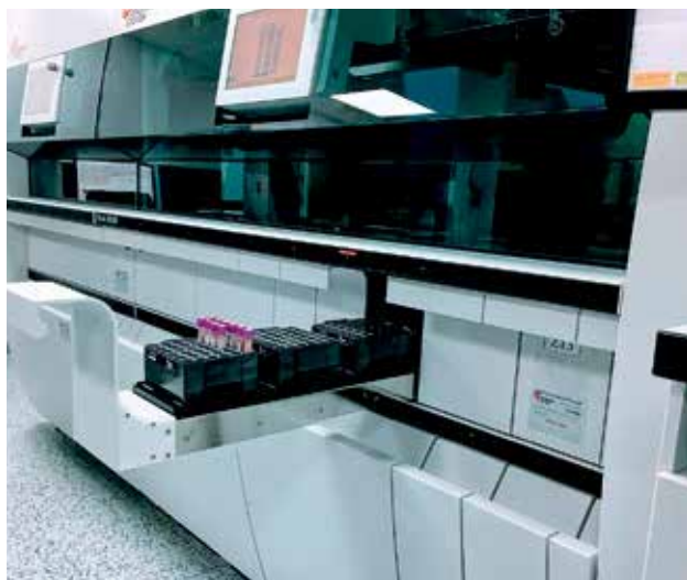
Obr. 3 Vkládání vzorků do DxA 5000, ostatní zajistí plně automatizovaný systém.
